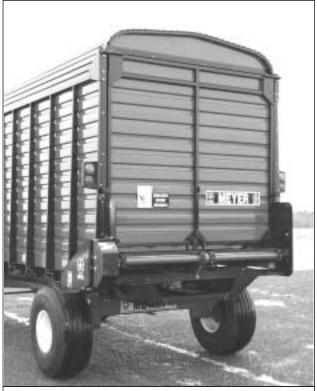
FIGURE 4. REAR OPENING DISCHARGE DOOR
